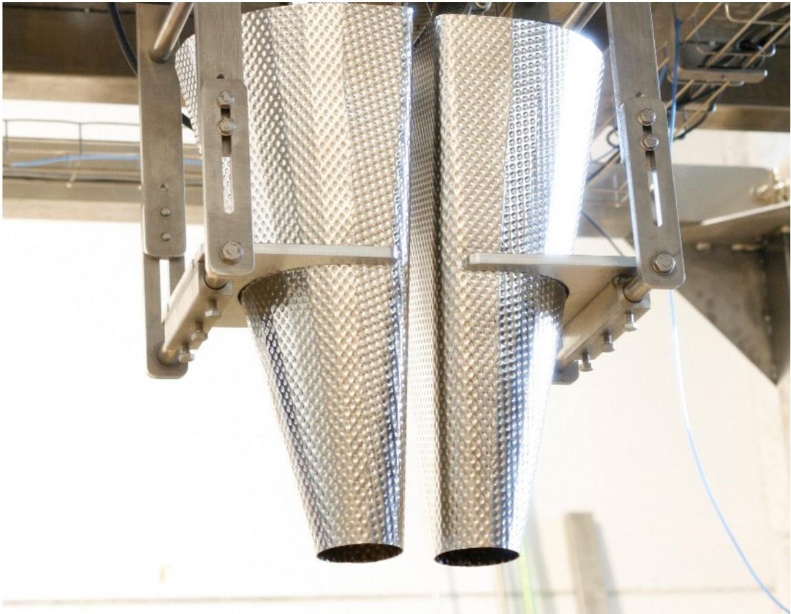
Doble embudo instalado en multicabezal para embocar en envasadora. Sistema especialmente diseñado para doble descarga dual, de forma automática. (Personalizado según necesidades de cada cliente)
