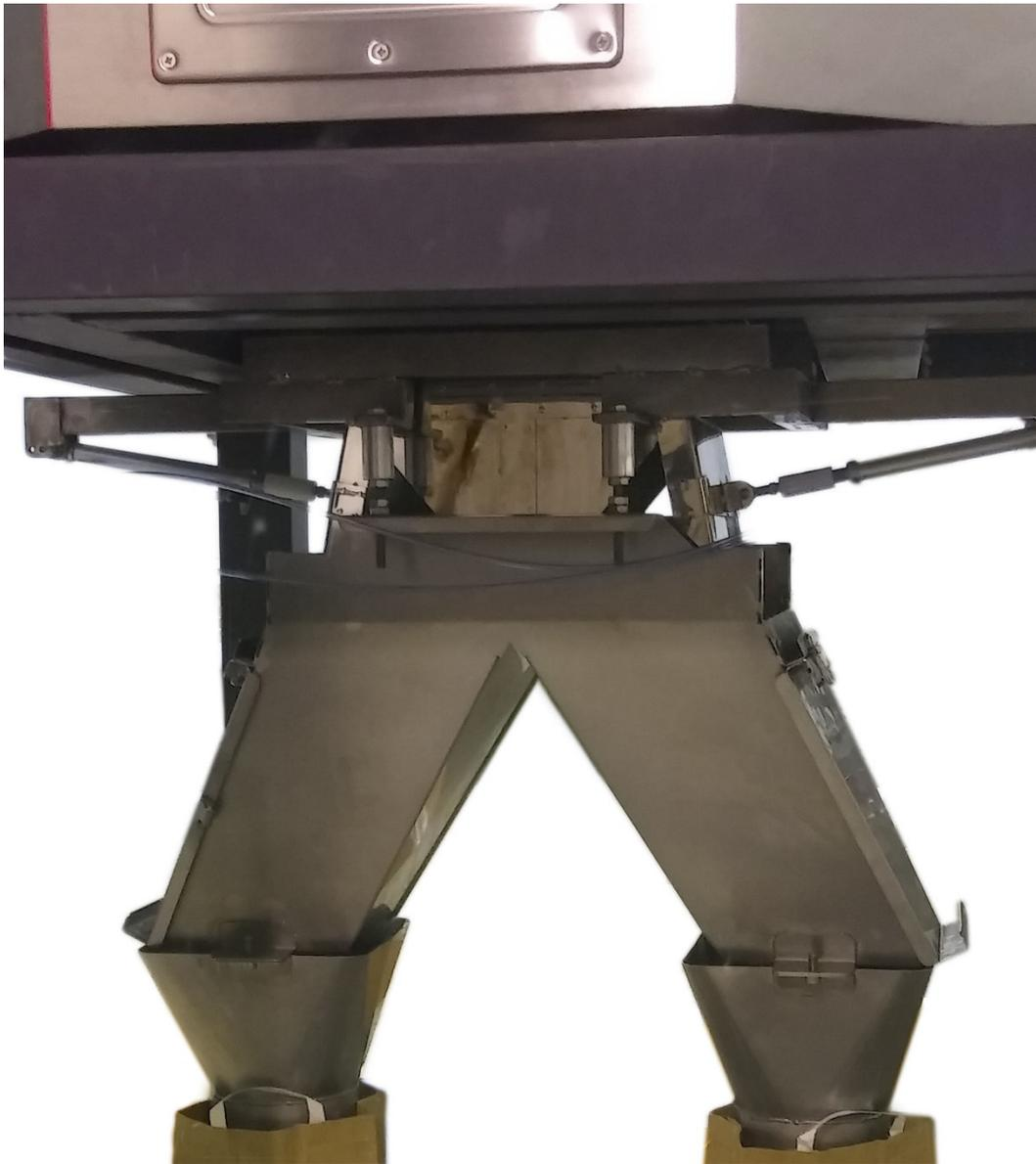
Doble descarga dual, especialmente diseñado para la dosificación de carbón, para el manejo de dos operarios.
